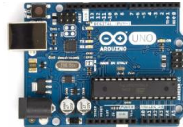
Figura 5. Características de Arduino UNO
