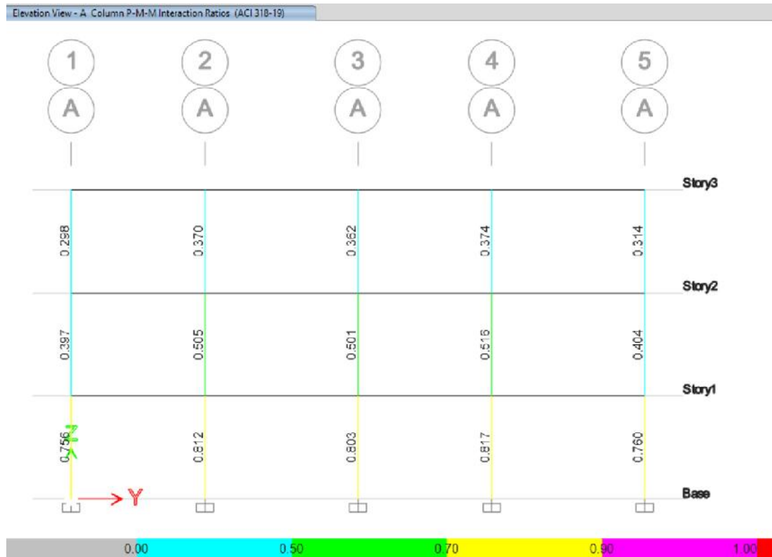
Figura 31: Radio de capacidad columnas
