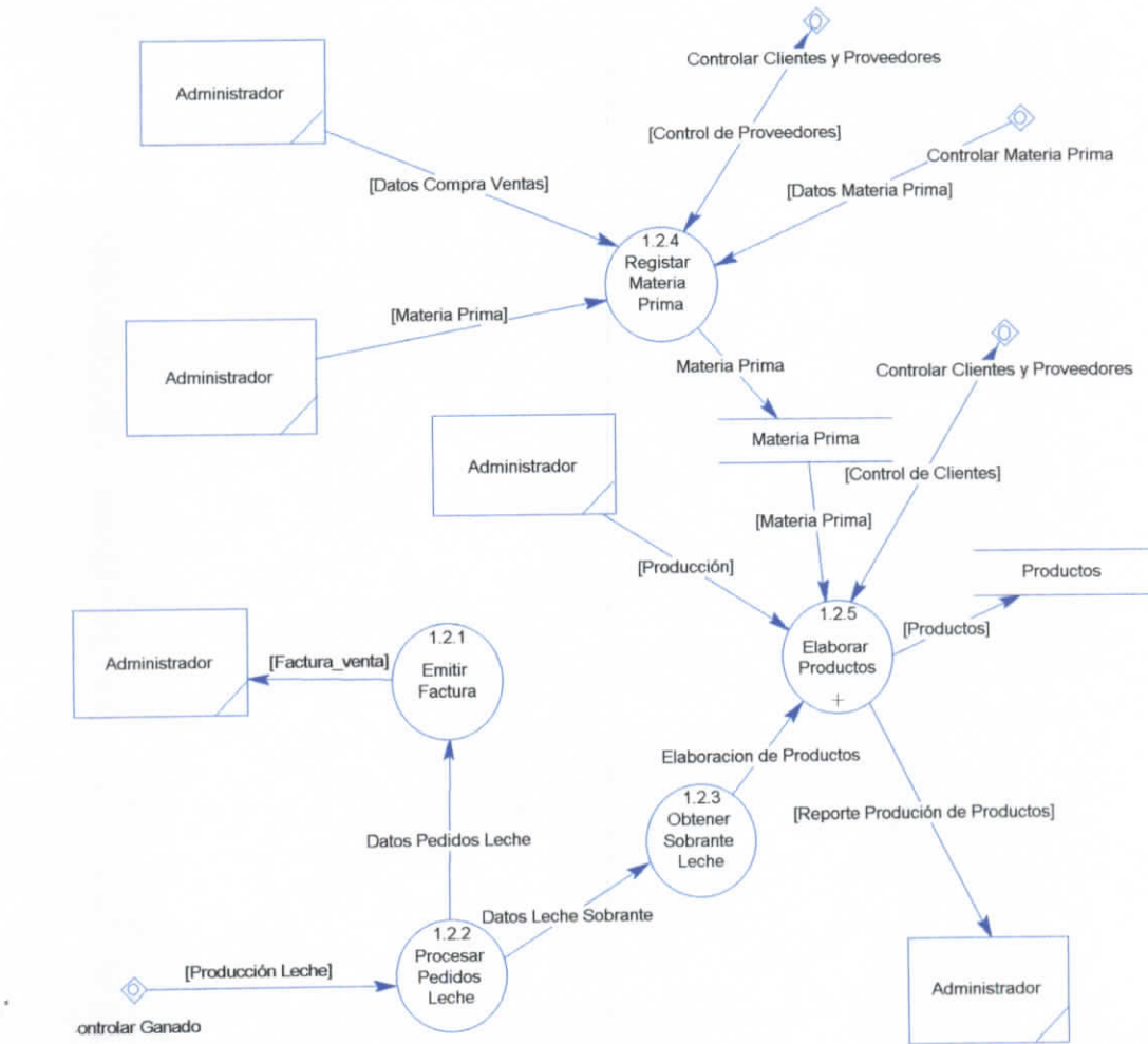
Fig. 6.5. DFD Nivel 2, Subproceso Producción
