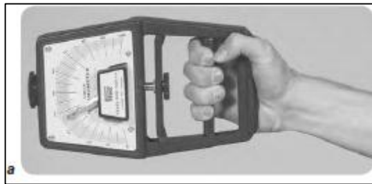
Figura 8. Dinamómetros para medir la resistencia estática: a) dinamómetro de mango, b) dinamómetro para medir espalda y piernas
