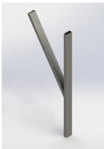
Imagen 4.18 Estructura en Y 301 x 690mm
