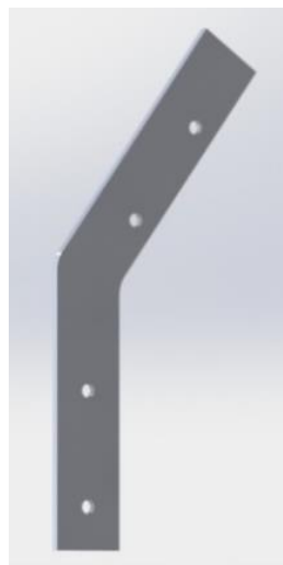
Imagen 4.13 Platina de 25 mm de ancho x 6.35 mm de espesor
