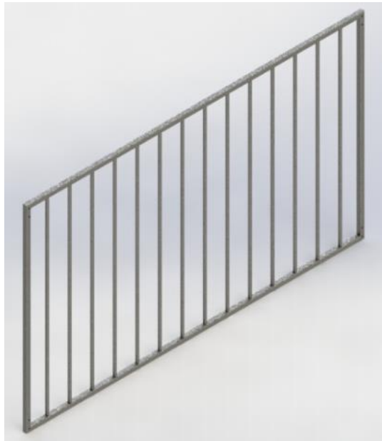
Imagen 4.10 Lateral Izquierdo 700 x1200 mm
