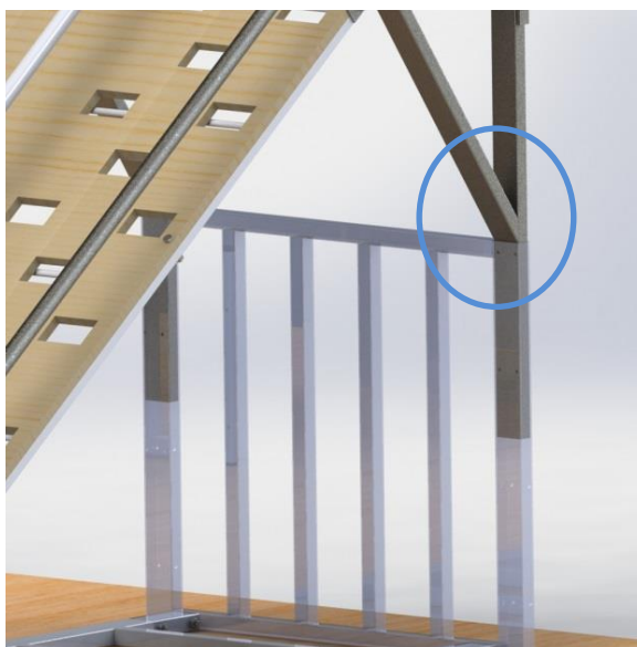
Imagen 4.17 Estructura en Y acoplada dentro de la estructura base
