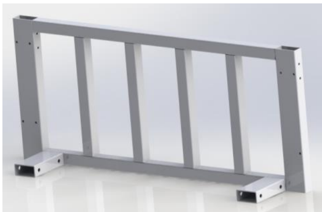
Imagen 4.8 Estructura inferior 300 x 700 mm
