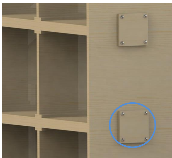
Imagen 4.21 Unión de cajones, sistema mecánico de tuerca y tornillo
