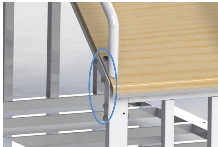
Imagen 4.28 Platina, sistema mecánico de tuerca y tornillo
