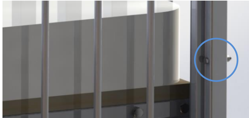
Imagen 4.22 Unión de estructura por puerca y tronillo
