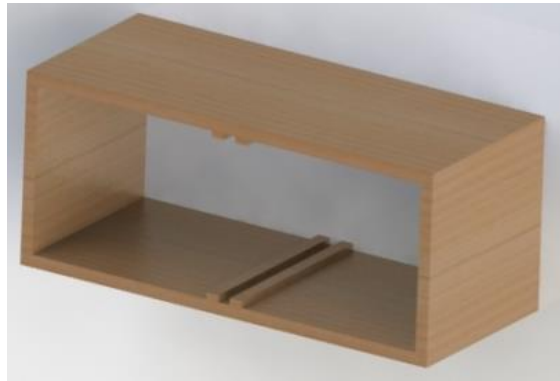
Imagen 4.14 Cajones 300 mm (a) x 600 mm (l) x 300 mm (p)
