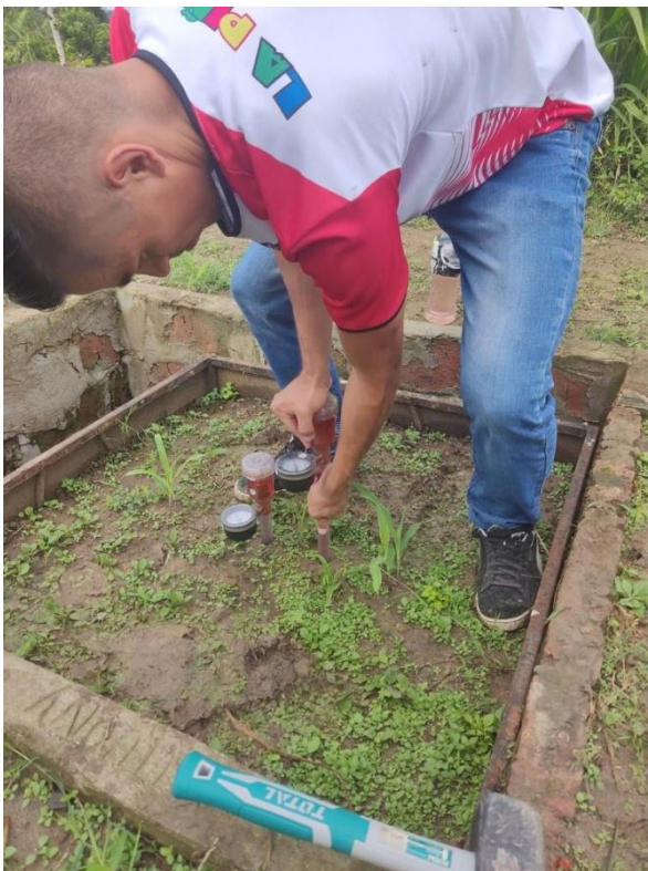
Ilustración 2: Instalación de tensiómetros en el lisímetro
