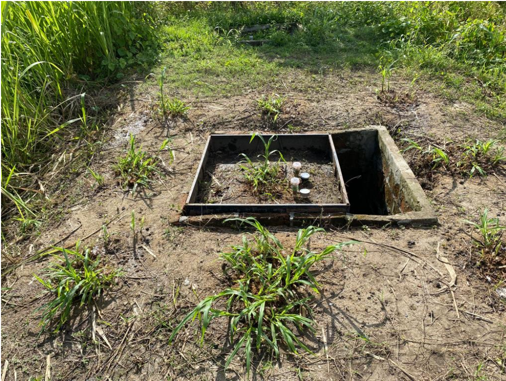
Ilustración 3: Lisímetro con sus 9 macollas
