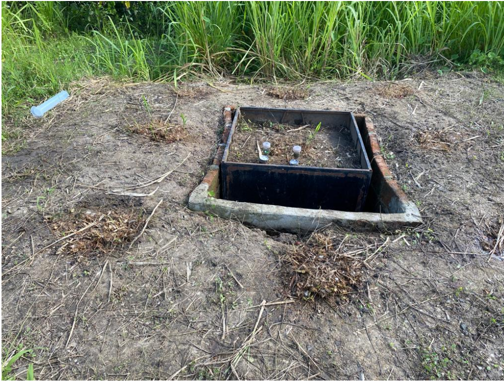
Ilustración 2: Instalación de tensiómetros en el lisímetro
