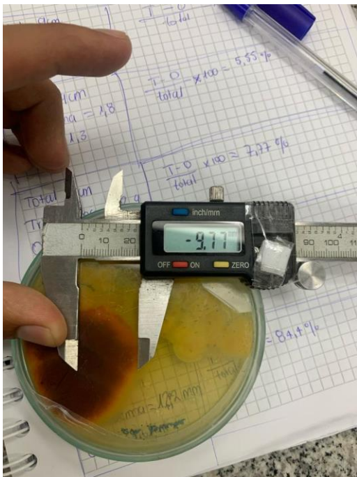
Medición con un calibrador de la confrontación de Trichoderma spp y oidio
