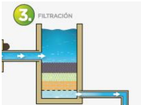
Imagen 6. Fase de filtración
