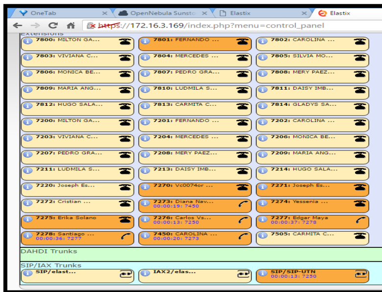
Figura 73. Establecimiento de una llamada a través de la troncal con servidor UTN Fuente: Servidor Elastix PBX-FICA
