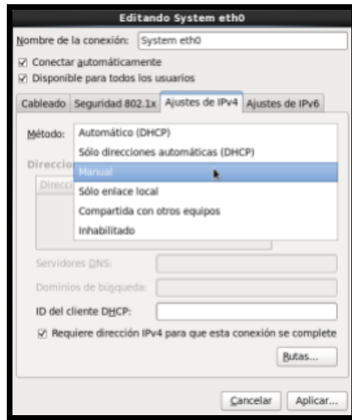
Figura 102. Configuración manual de interfaz de red Fuente: Eucalyptus Faststart ISO
