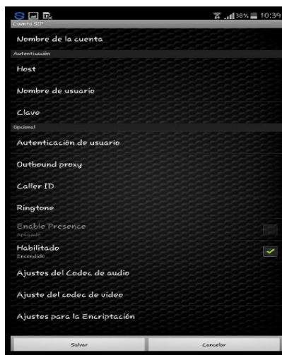
Figura 173. Configuración de los parámetros de extensión Fuente: Software Zoiper
