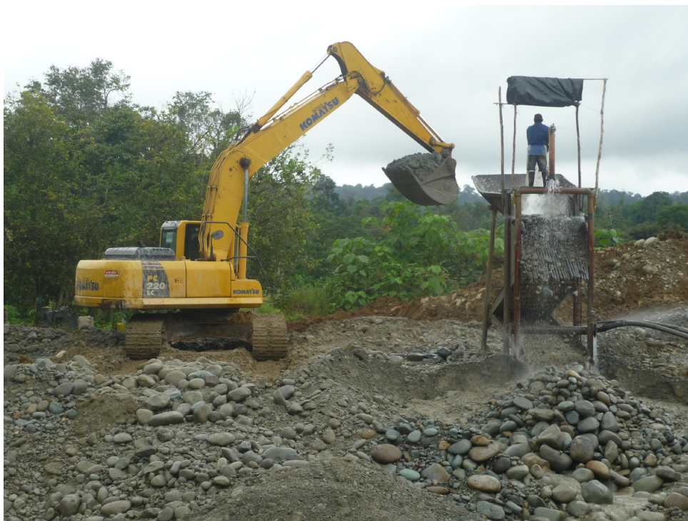
Fotografía 2: Explotación minera en proceso de trabajo: Excavadora, clasificadora y “Chorrero”
