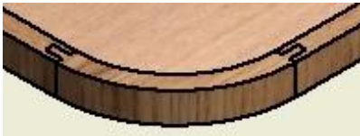
Figura 106. Unión de piezas con junta de lengüeta y ranura para juego de mesa. Elaboración propia.
