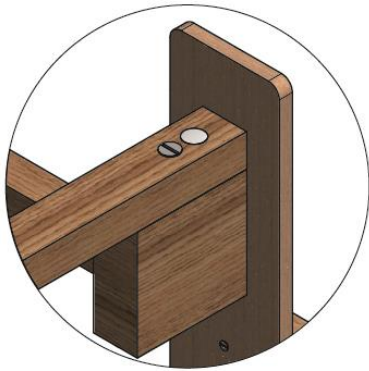
Figura 111. Unión de piezas fijas con tornillos. Elaboración propia.
