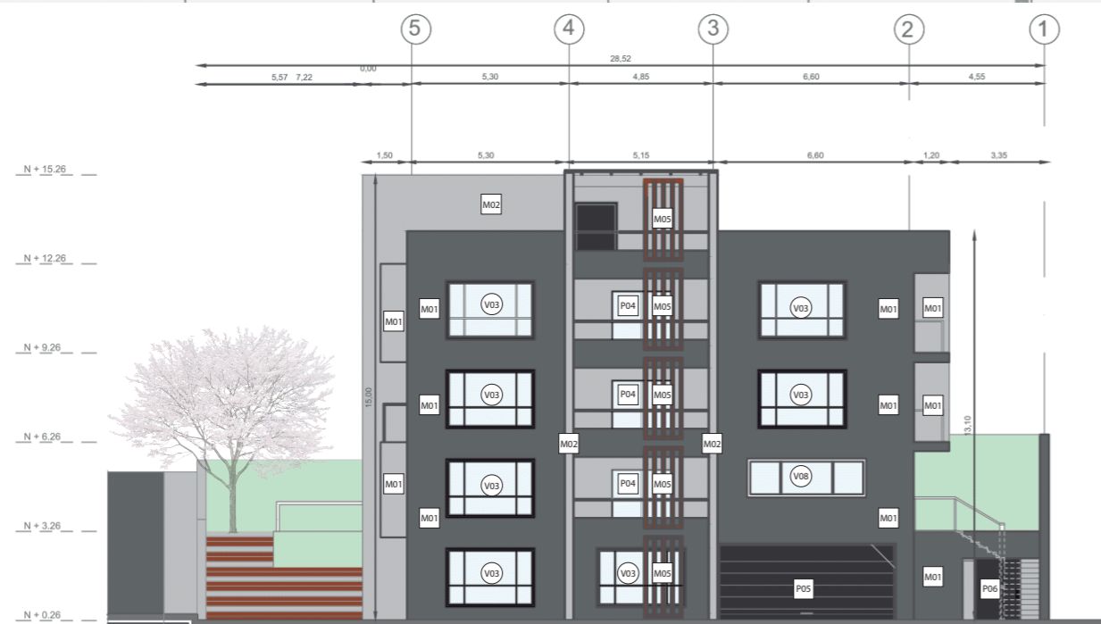
FACHADA LATERAL DERECHA CONSTRUCTIVA
