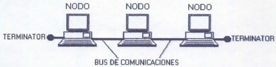
FIGURA 5 Topología en Bus Lineal
