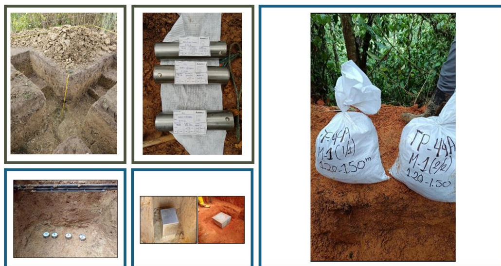
Figura 20.- Muestreo en las calicatas realizadas.
