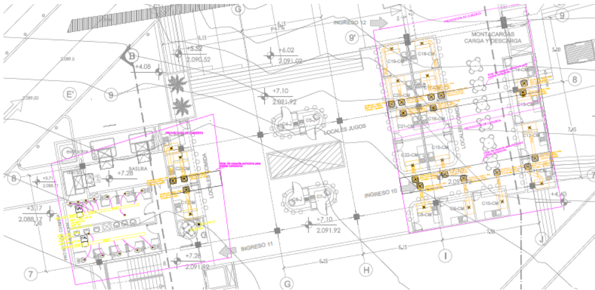
Figura 106. Climatización y Ventilación Planta Alta N+7.10
