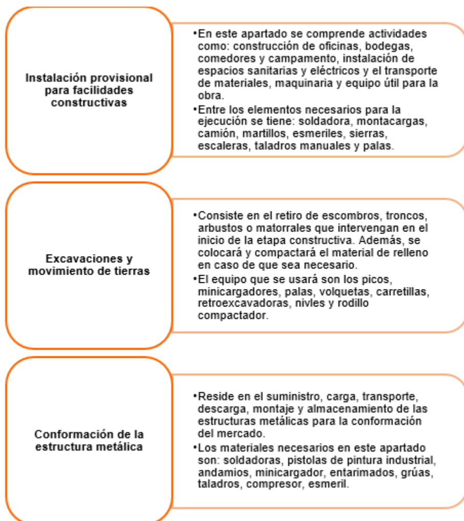
Figura 115. Actividades y equipos a emplear durante la etapa constructiva
