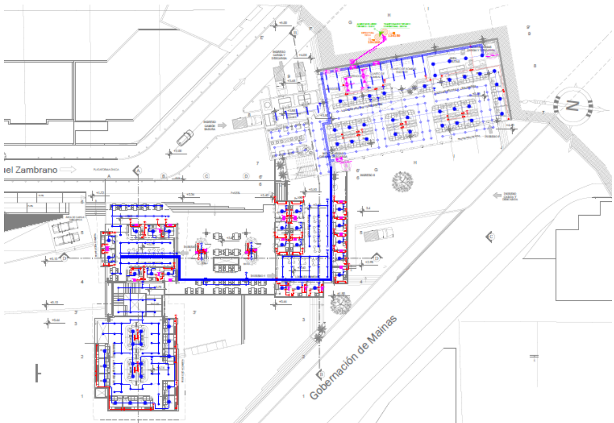
Figura 100. Tomacorrientes normales, iluminación interior Planta Alta N+3.60
