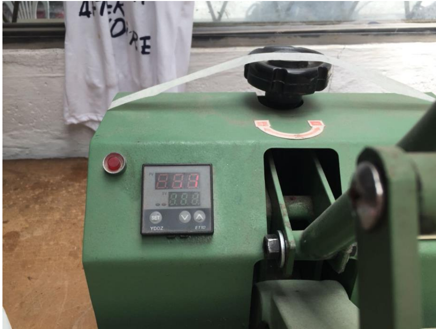
Control de temperatura de plancha
