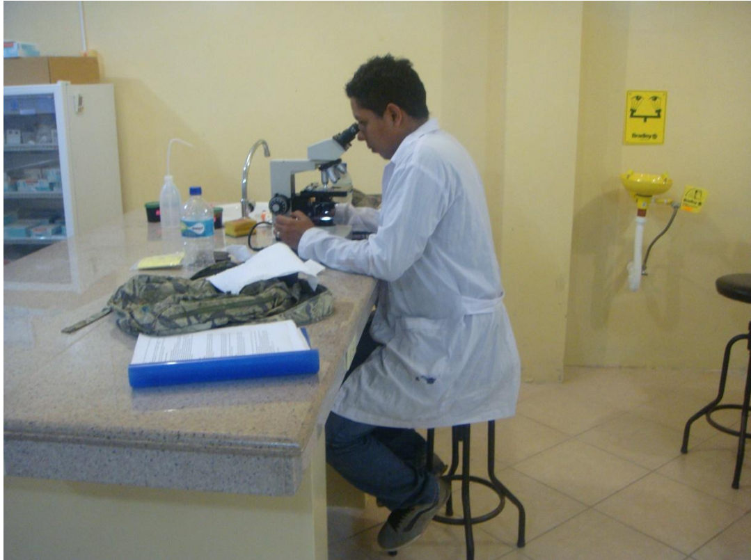
Fotografía #26: Observación de 1 ml de agua de muestra en una cámara de Sedgewick - Rafter bajo un microscopio óptico.
