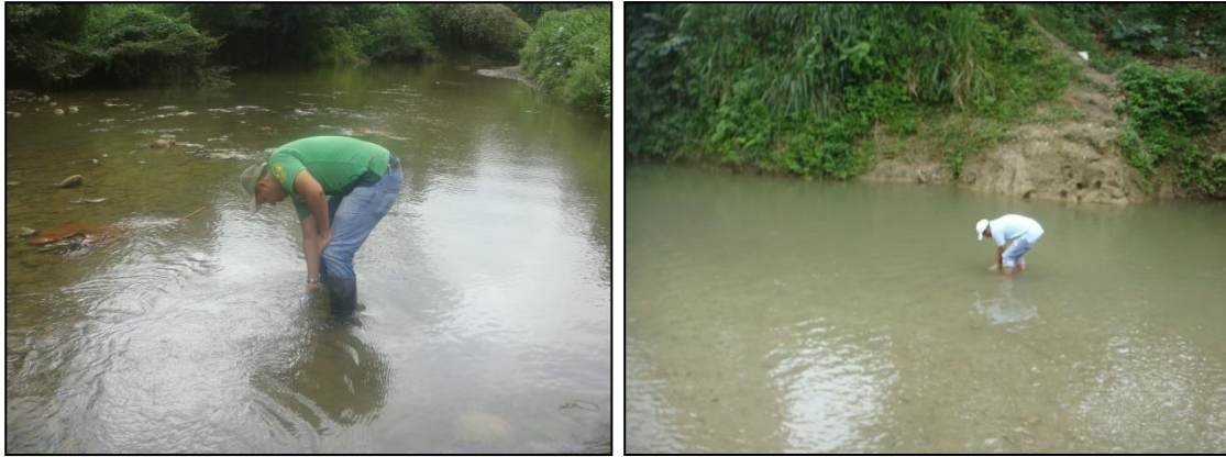
Fotografía #12 y #13: Toma de muestras con botellas de 500 ml.
