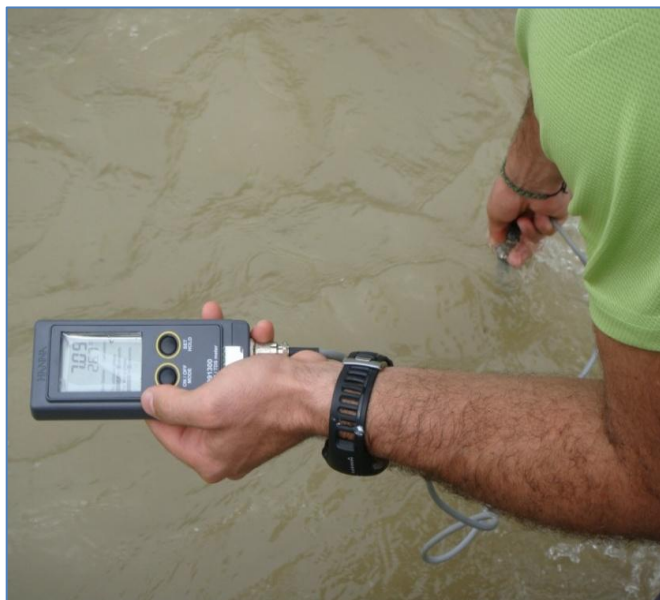
Fotografía # 11: Multiparametros. (Hanna Instrument 991001)
