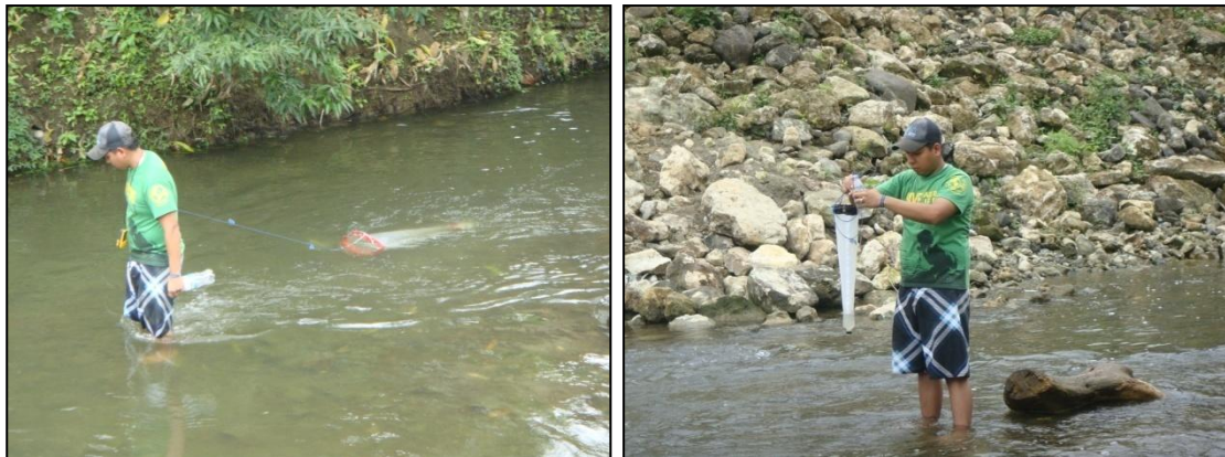
Fotografía # 14 y #15: Toma de muestras con redes de arrastre de 53 \mu\text{m} y 60 \mu\text{m} .
