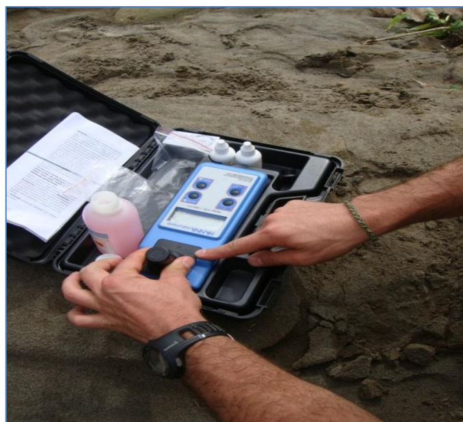
Fotografía # 10: Turbidímetro. (Hanna Instruments 93703)
