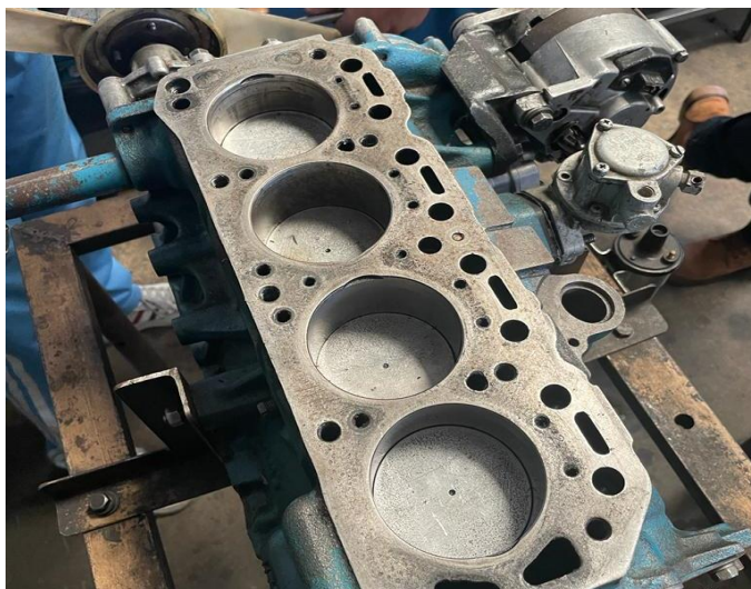
Registro Fotográfico 7. Numero de cilindros del motor
