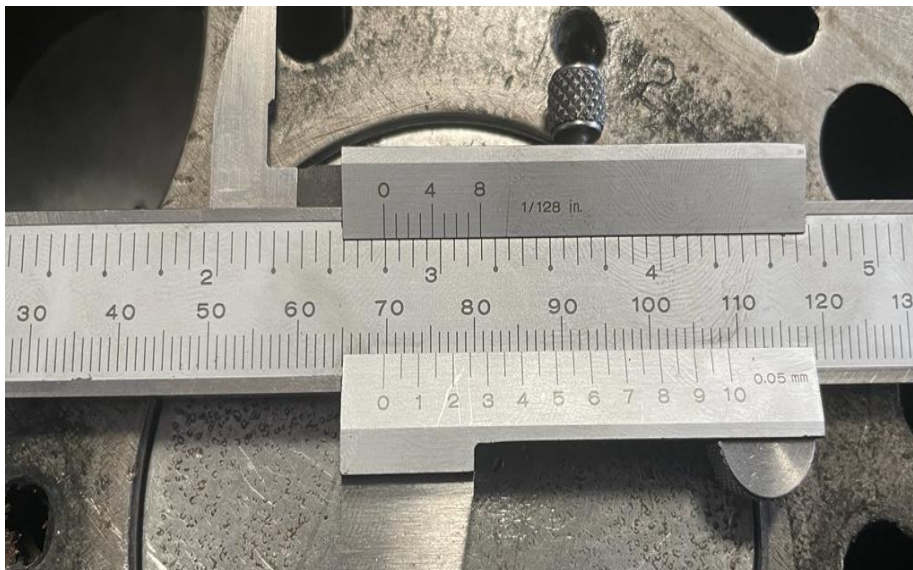
Registro Fotográfico 5. Medida obtenida de la carrera de pistón
