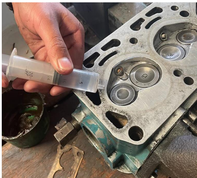
Registro Fotográfico 6. Obtención del volumen de la cámara de combustión
