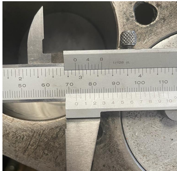
Registro Fotográfico 3. Medida obtenida del diámetro del cilindro
