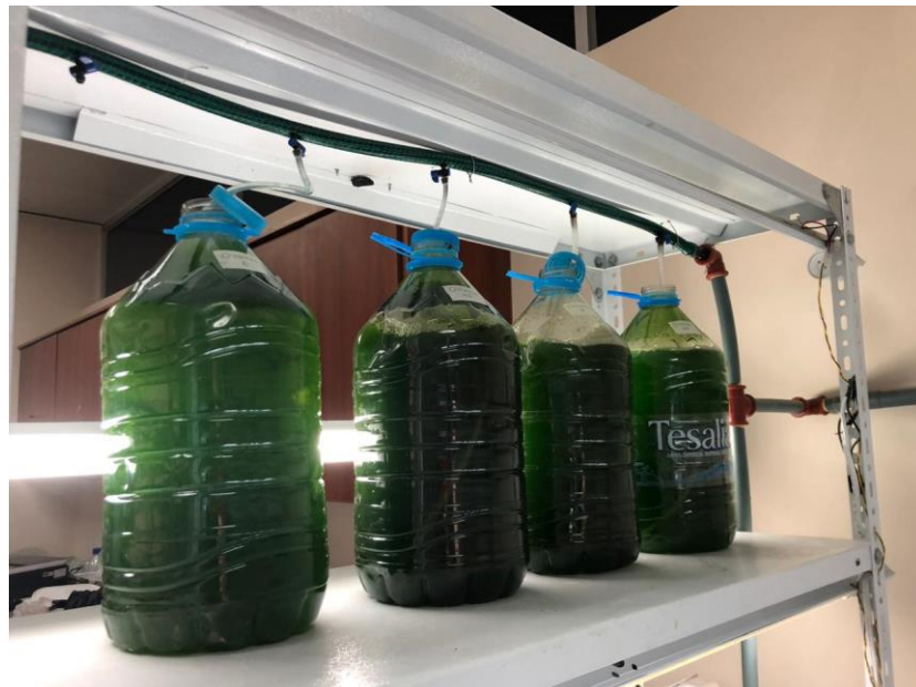
Fotografía 2 Producción de microalgas en el laboratorio Fuente: El Autor
