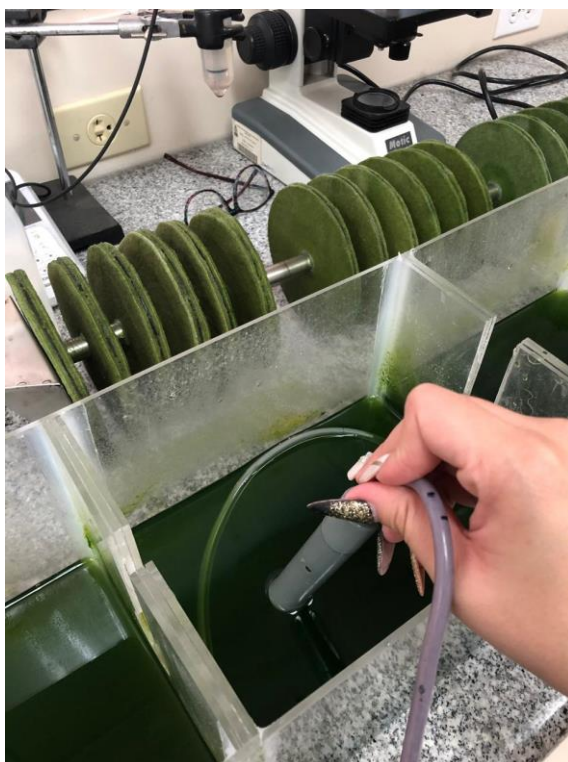
Fotografía 15 Medición de la Conductividad el agua tratada Fuente: El Autor
