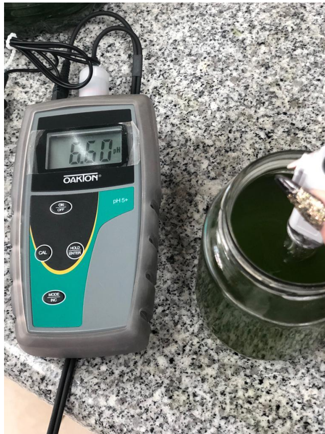
Fotografía 14 Medición del pH en el agua tratada Fuente: El Autor
