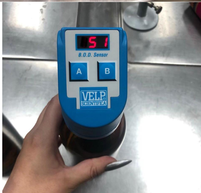
Fotografía 17 Medición de la DBO el agua tratada Fuente: El Autor
