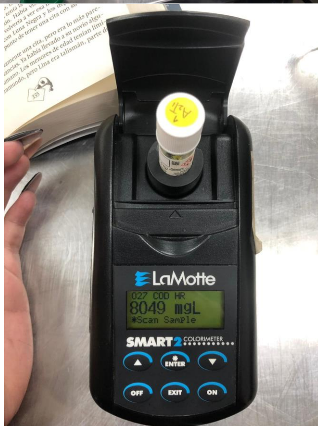
Fotografía 18 Medición de la DQO el agua tratada Fuente: El Autor
