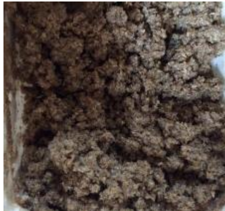
Imagen 4.9 Mezcla de desechos pulverizados de MDF con resina poliéster.
