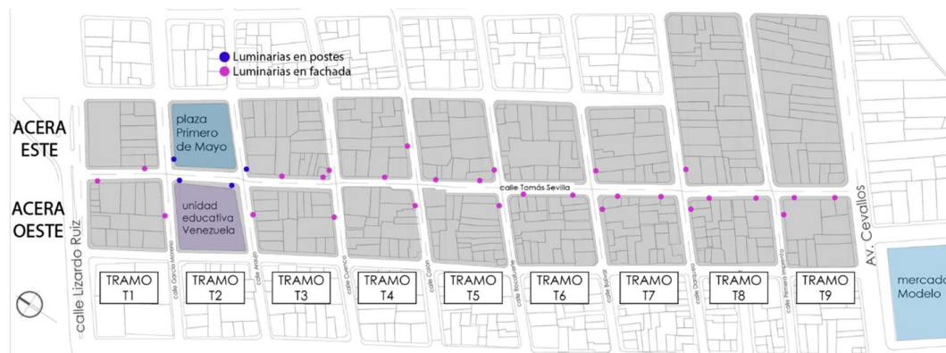
Figura 13. Disposición de alumbrado público en la calle Tomás Sevilla.
