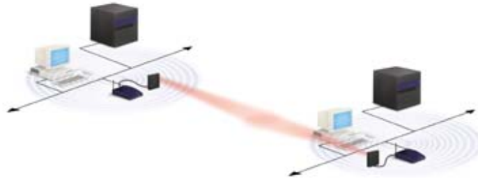
Gráfico 6. Utilización de antenas direccionales 26
