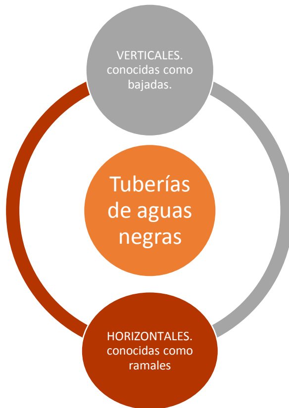
Figura 5. 5: Clasificación de tuberías de aguas negras.
