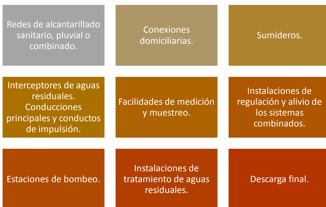
Figura 5. 7: Componentes del sistema de drenaje urbano.
