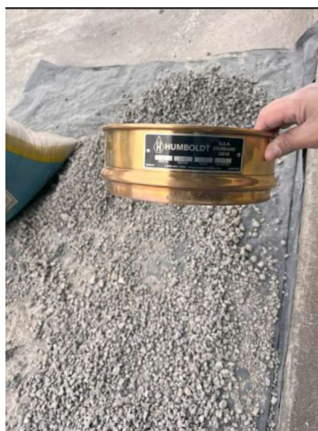
Ilustración 8. Tamizado para obtener la fracción deseada como sustituto del agregado fino.
