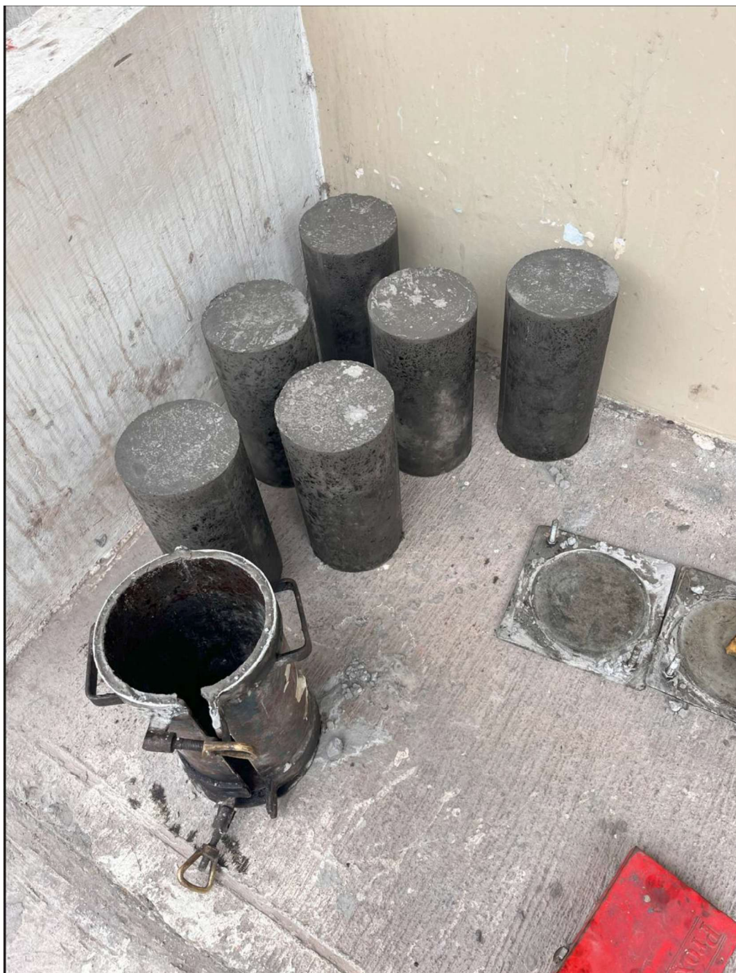
Ilustración 21. Desmolde de Cilindros de hormigón (muestra patrón)
