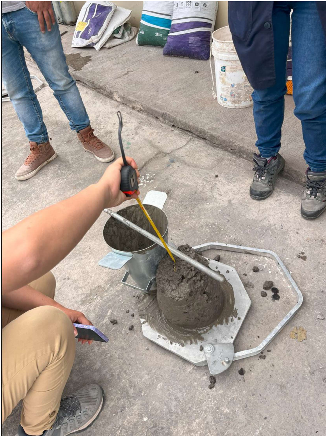
Ilustración 19. Verificación de asentamiento 80mm
