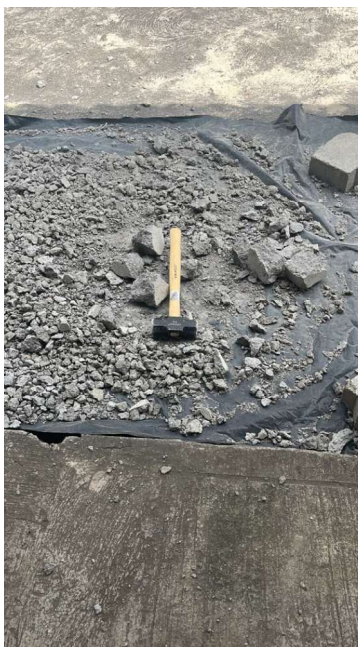
Ilustración 8. Tamizado para obtener la fracción deseada como sustituto del agregado fino.
