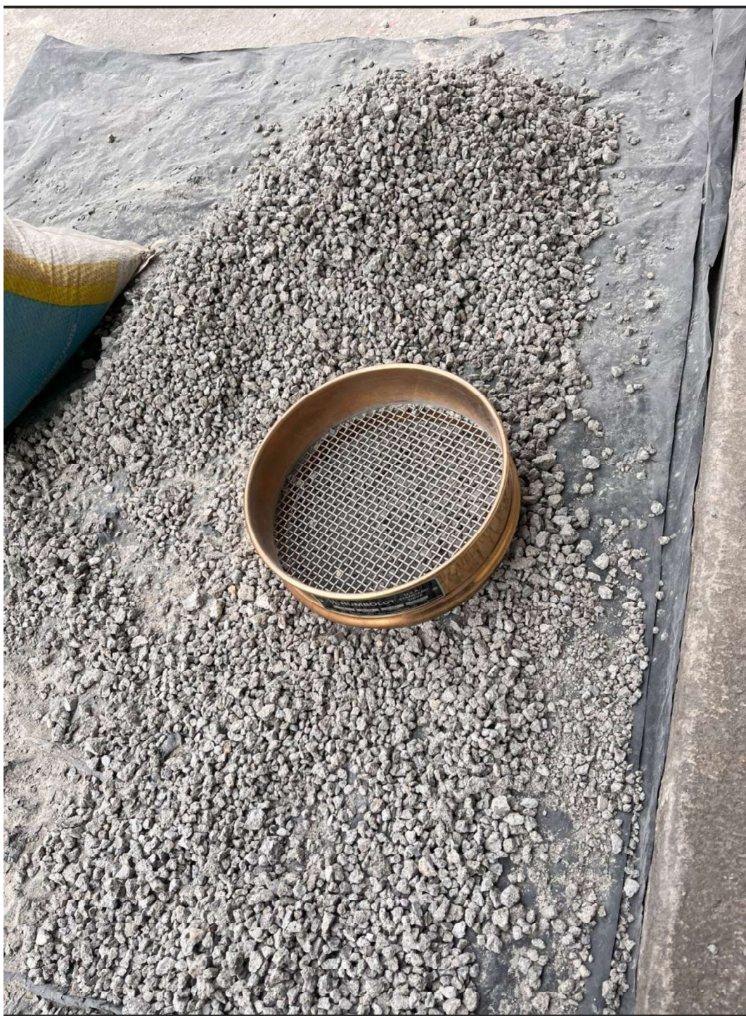
Ilustración 22. Tamizaje de material triturado manualmente (desecho de adoquín)
