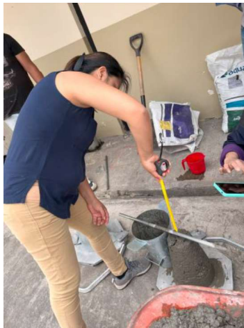
Ilustración 11. Verificación de asentamiento 80cm
