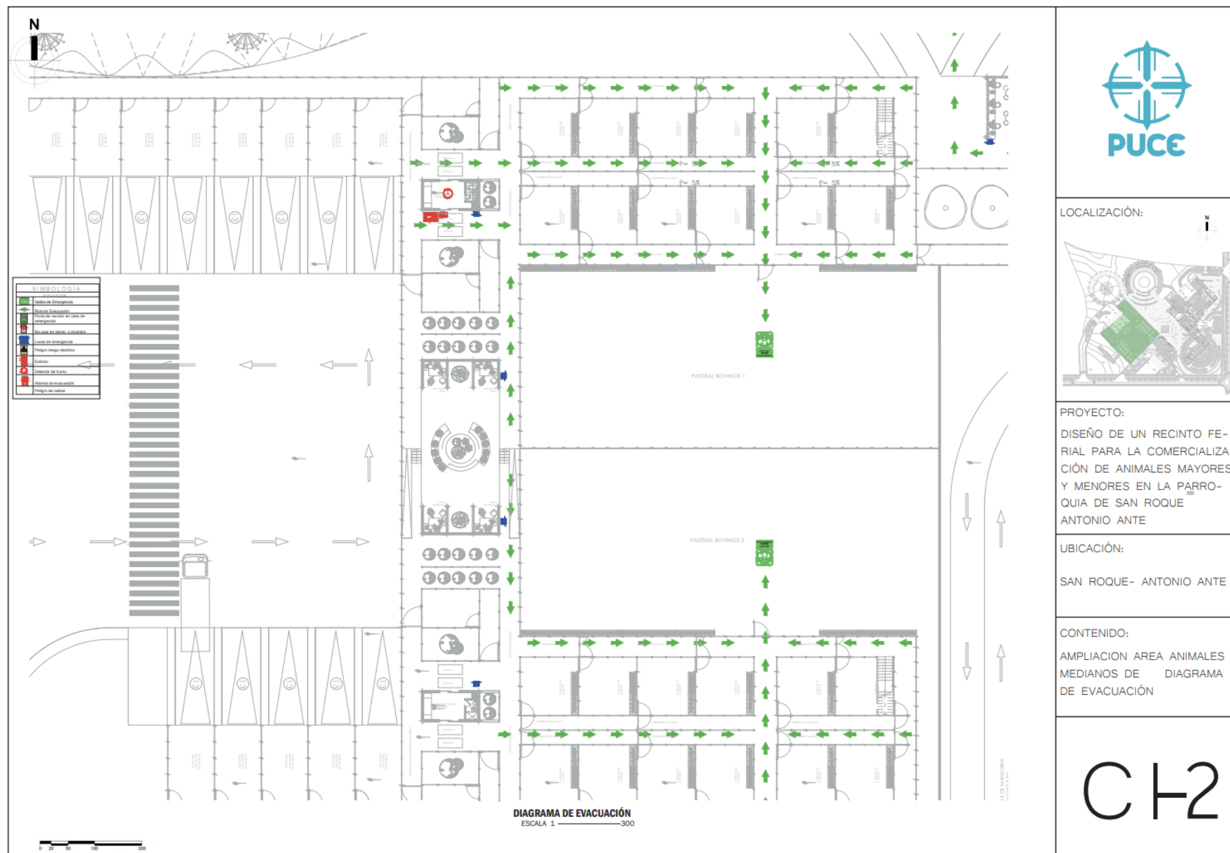
Figura 140: Diagrama de evacuación sección bovinos
