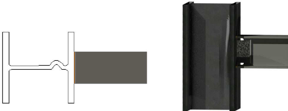
Ilustración 23 Esquema de aplastamiento del alma (elaborado por el autor)
