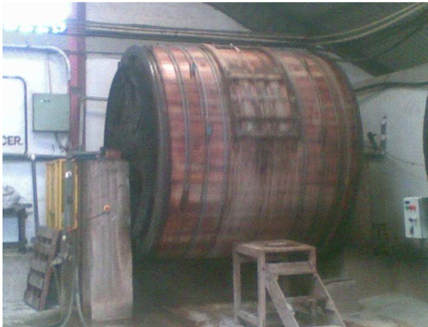
Fotografía 2: Remojo y lavado
