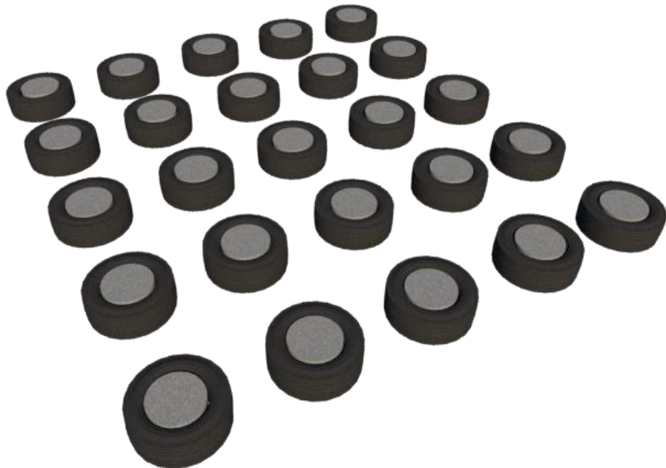
Ilustración 59. Neumáticos rellenos de hormigón para mayor estabilidad. Elaborado por: El Autor
