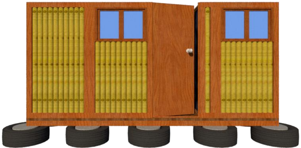
Ilustración 64 Vista frontal del ModuOrg, módulos con ventanas (iluminación), sistema de cimentación y entablado Elaborado por: El Autor
