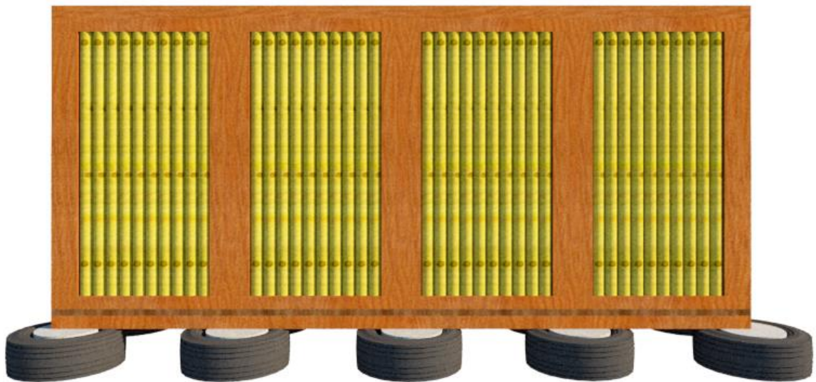
Ilustración 65 Vista Lateral conformación de 4 módulos originales de 1.20 cm por 1.20 cm que generan un muro. Elaborado por: El Autor
