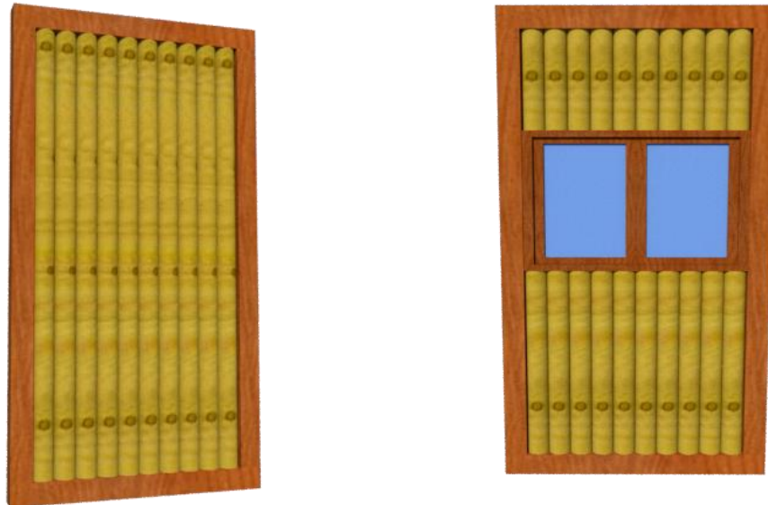
Ilustración 56 Módulos conformados por bastidores de madera y caña guadua rolliza. Elaborado por: El Autor
