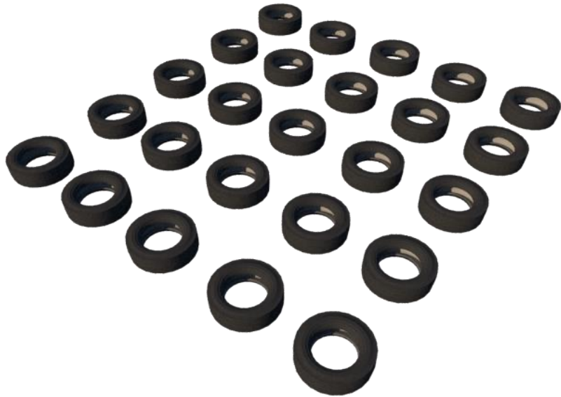
Ilustración 58. Cimentación neumáticos reciclados. Elaborado por: El Autor
