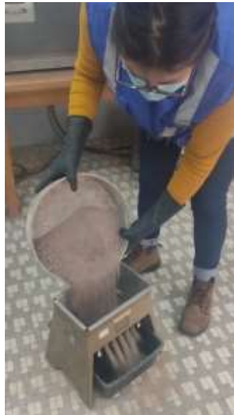
Figura 3.3 Método de Cuarteo – Agregado Fino
