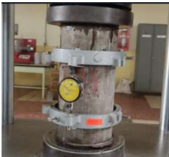
Figura 5.1 Especimen de hormigón, con equipo para determinación de deformaciones longitudinales.
