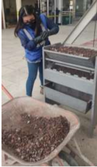
Figura 3.2 Método de Cuarteo - Agregado Grueso
