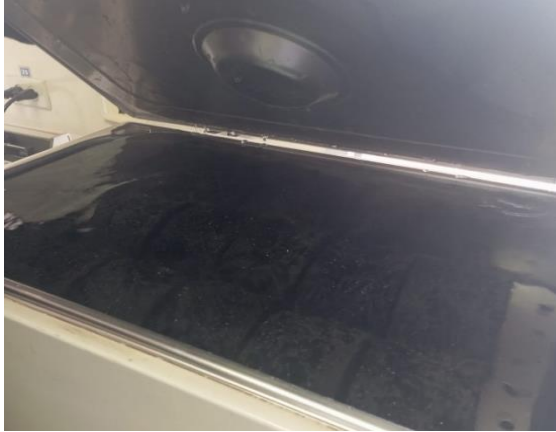
Ilustración 4-3 Briquetas sumergidas para ensayo Marshall
