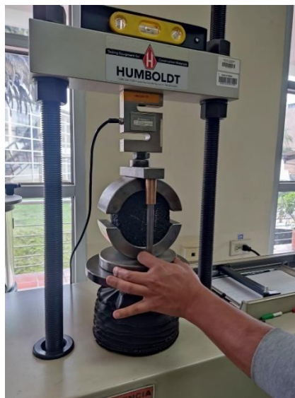
Ilustración 4-4 Briqueta en la máquina de ensayo
