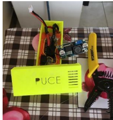
Figura 30 Ensamble del módulo ESP8866
