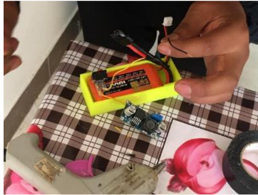
Figura 29 Acople de Módulo DC Lm 2596
