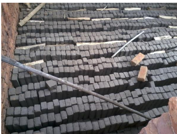
Gráfico 5.16: Carga de hornos para la cocción
