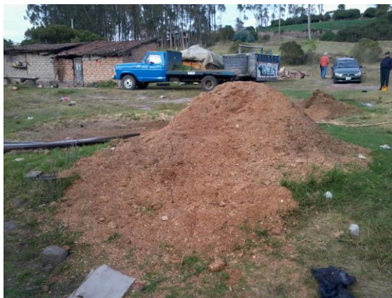
Gráfico 5.13: Aserrín y plástico para la mezcla del ladrillo
