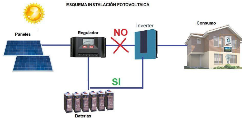
Figura 41 Esquema de regulador de carga e inversor independientes [27]
