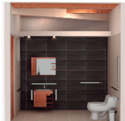
Baño exterior para personas con capacidades especiales
