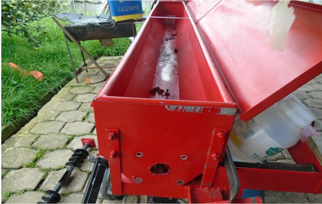
Fotografía 2: Montaje de la tolva y sus accesorios en el chasis
