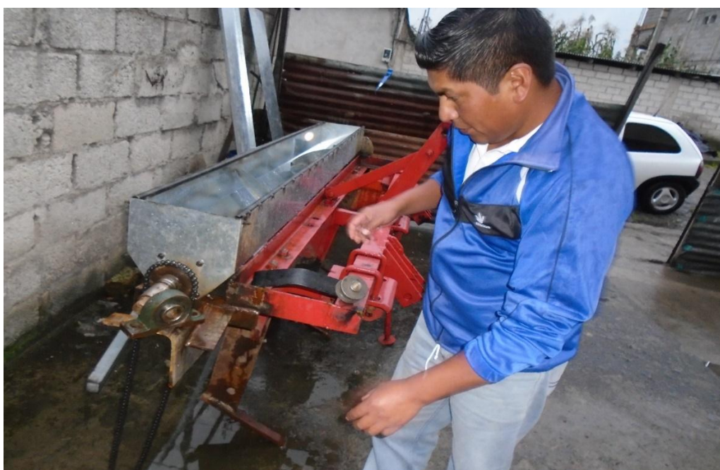
Fotografía 1: Montaje de la tolva y sus accesorios en el chasis
