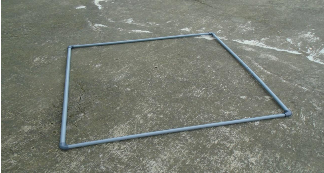
Fotografía 23: Instrumento terminado 1m x 1m para cortar las muestras de las parcelas
