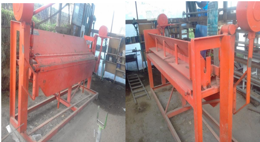
Fotografía 49: Dobladora de toles parte frontal y posterior.
