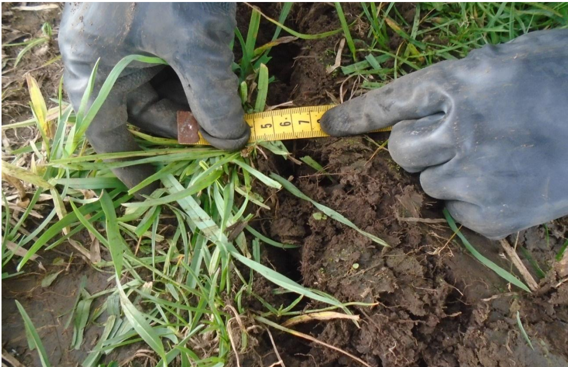
Fotografía 12: Evidencia de la anchura del corte del subsolador a 0.3cm
