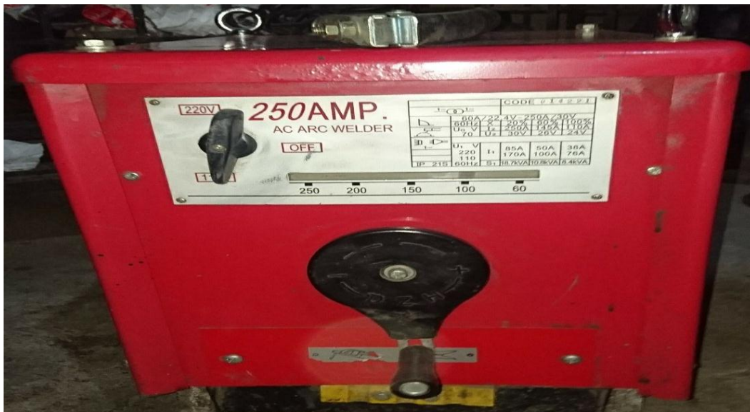
Fotografía 48: Tipo de soldadora utilizado durante la elaboración del subsolador
