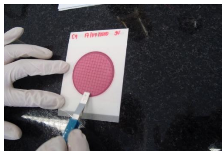
Fig. 8 Membrana lista para incubar.
