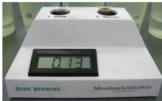
Fig. 1 Turbidímetro utilizado para realizar la Solución Madre.
