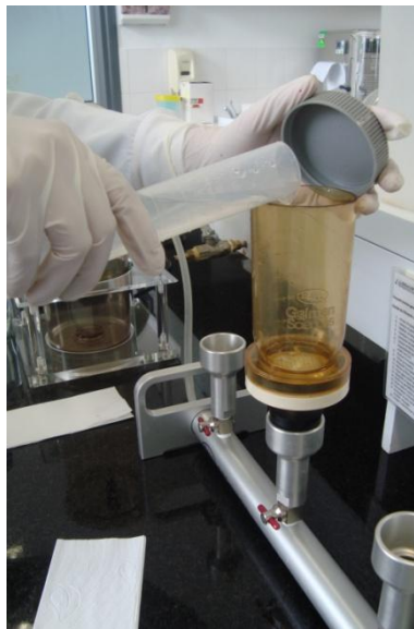
Fig.5 Colocar 100 ml de la muestra.
