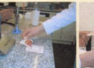
Paso 3: Se coloca una membrana de 0,45 \mu\text{m} de poro sobre el equipo de filtración
