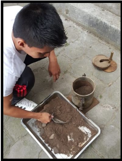
Fotografía A.11. Preparación del molde para CBR.
