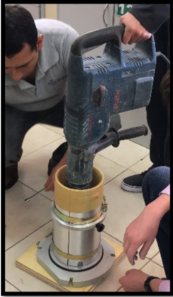
Fotografía A.17. Compactación de la muestra.
