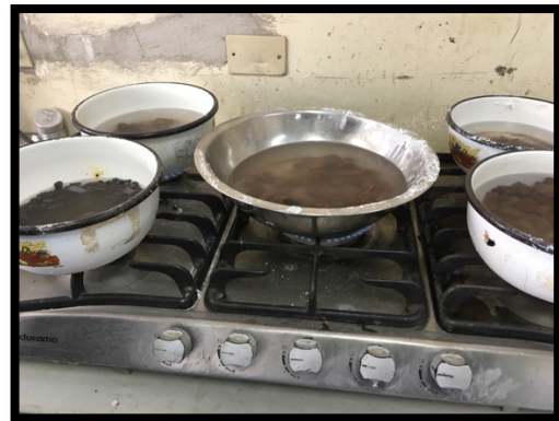
Fotografía A.4. Extracción del sulfato de los agregados fino y grueso.
