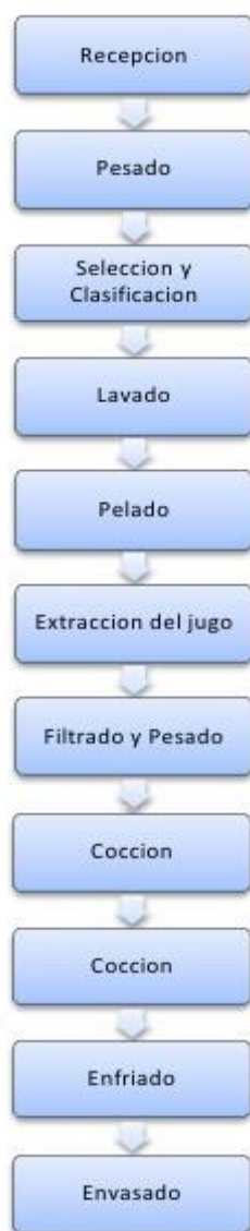
Gráfico 5.6. Diagrama de flujo de procesos de elaboración de la Mermelada Dietética.
