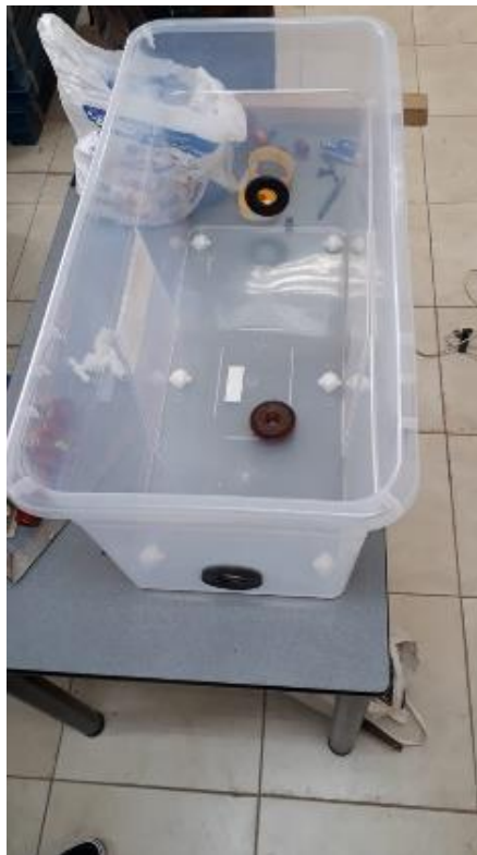
Fotografía 4. Orificios en los tanques para colocación de accesorios y tuberías. (Fuente: Fotografía de Paula Jaramillo y Jack Vásquez)
