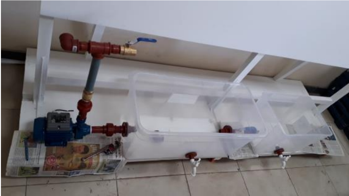
Fotografía 7. Unión tanques y bomba. (Fuente: Fotografía de Paula Jaramillo y Jack Vásquez)
