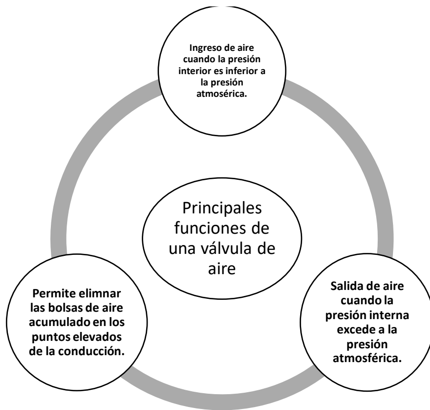
Figura 37. Funciones de una válvula de aire en una línea de conducción de agua potable. (Iglesias-Rey, Fuertes-Miquel, García-Mares, & Martínez-Solano, 2016)
