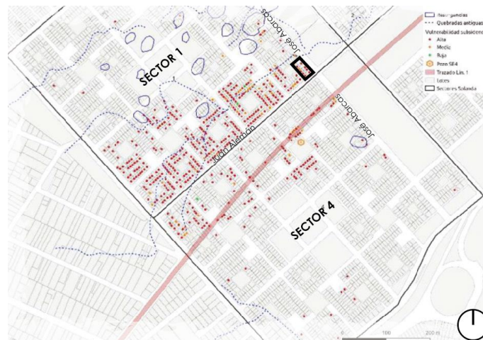
Figura 23: Vulnerabilidad por subsidencia de las viviendas inspeccionadas en los sectores 1 y 4
