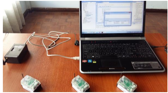
Fig. N° 6 Estación base en funcionamiento con la aplicación monitora Ping
