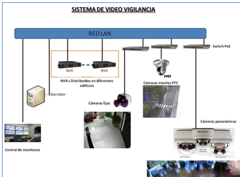
Figura 24: Diagrama del sistema de video vigilancia
