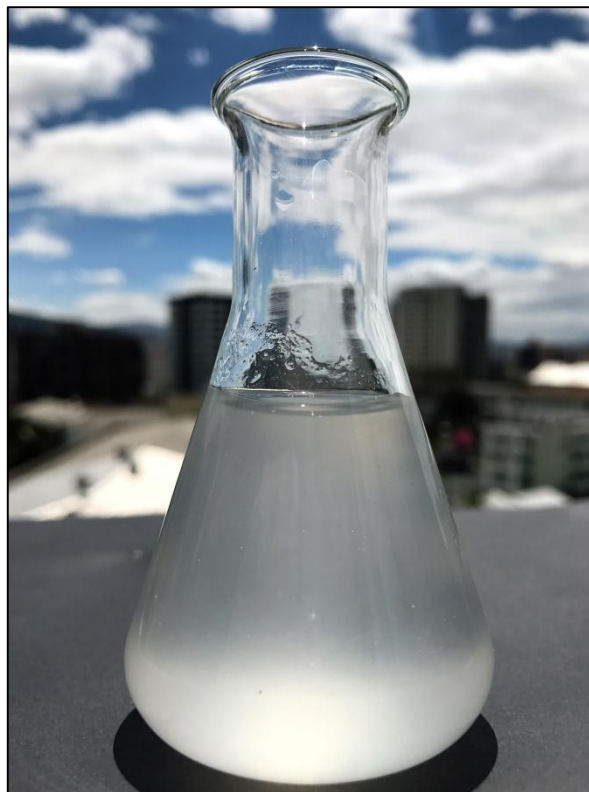
Figura 11. Matriz de nanocelulosa fibrilada de tagua y alginato de sodio. Matriz de inmovilización de levaduras Saccharomyces cerevisiae .
