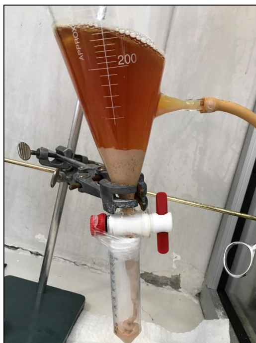
Figura 20. Sólidos y levaduras precipitadas en el embudo de separación del sistema semi-continuo.
