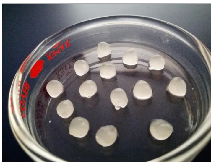
Figura 12. Perlas poliméricas con levaduras inmovilizadas.
