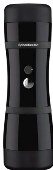
Figura 5. Esferificador®. Sistema utilizado para inmovilización de levaduras ( S. cerevisiae ) en matriz de nanocelulosa de tagua y alginato de sodio.
