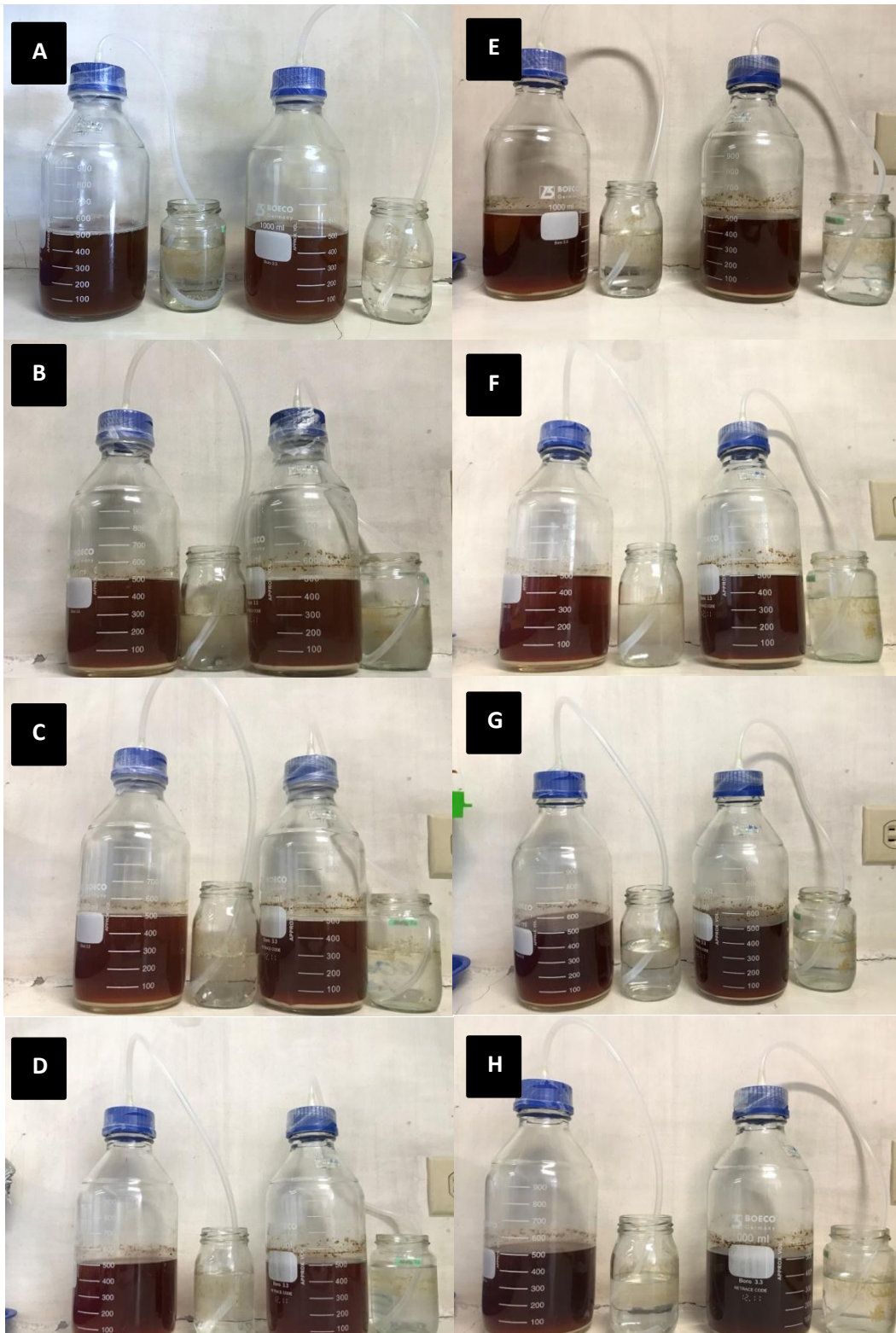
Figura 17. Sistemas de fermentación en batch. A. día 1; B. 3 días; C, 5 días; D, 7 días; E, 9 días; F, 11 días; G, 13 días; H, 15 días.
