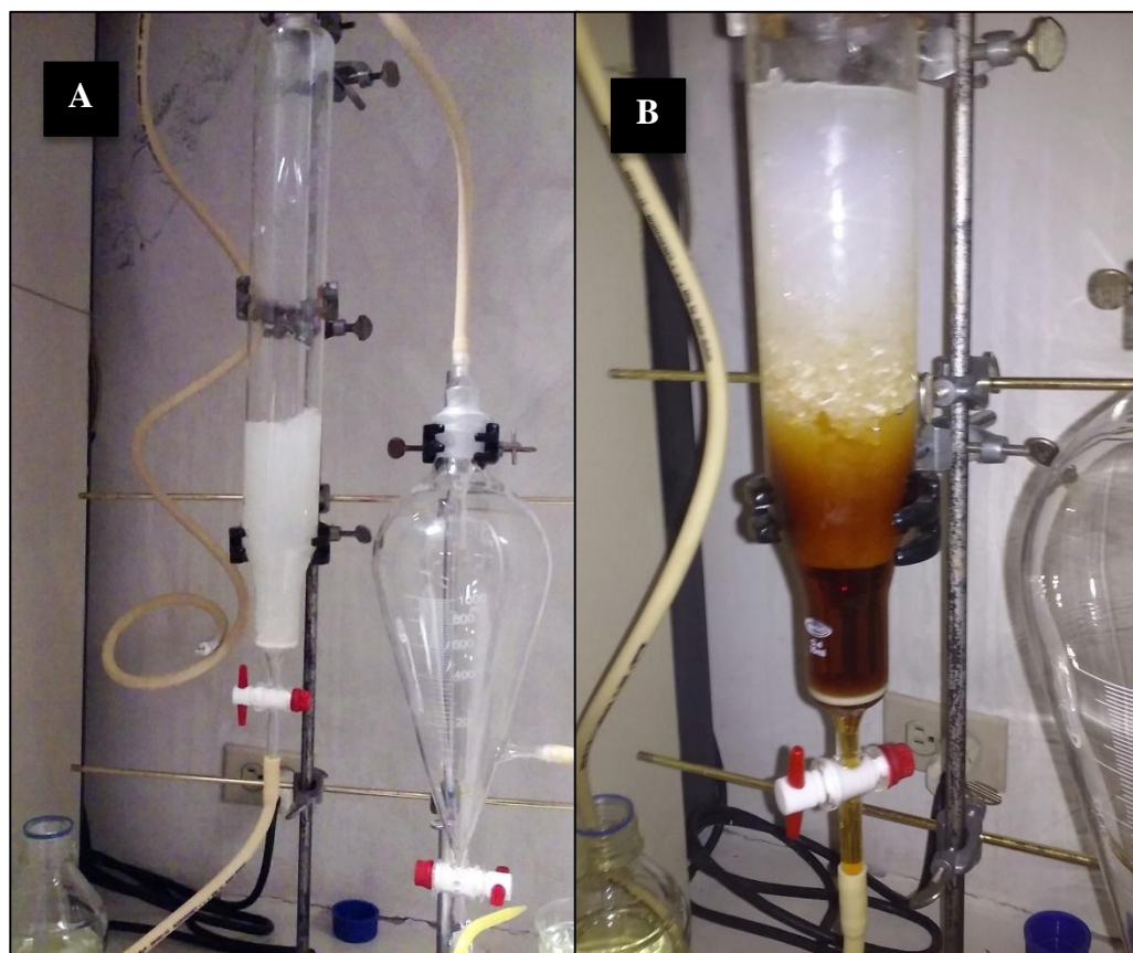
Figura 6. Columna del SFSC. A, empacutada con perlas de levaduras Saccharomyces cerevisiae inmovilizadas en matriz de nanocelulosa y alginato de sodio; B, alimentación con mosto cervecero a la columna de fermentación
