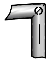
DETALLE C ESCALA 1 / 10 Platina de 4 mm de espesor con dos orificios de 5 mm, soldada a la estructura. Para unir con los dos módulos mediante tirafondo de 1/2 por 1/4
