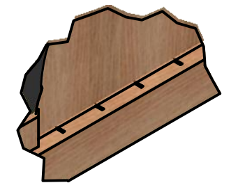
DETALLE A Escala 1:10 Los laterales de la llantas tapadas se encuentran unidos mediante tornillos por la parte de abajo.
