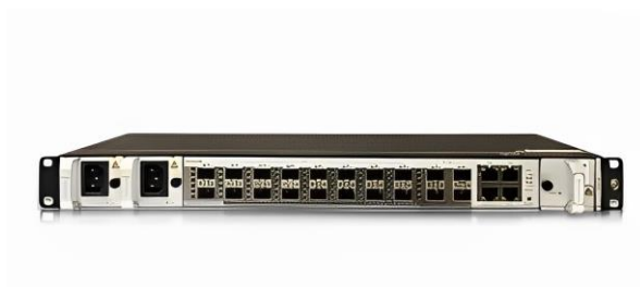
Figura 10 OLT Huawei OptiXaccess EA5801E-GP16 Fuente: (Huawei Technologies Co., Ltd, 2022)
