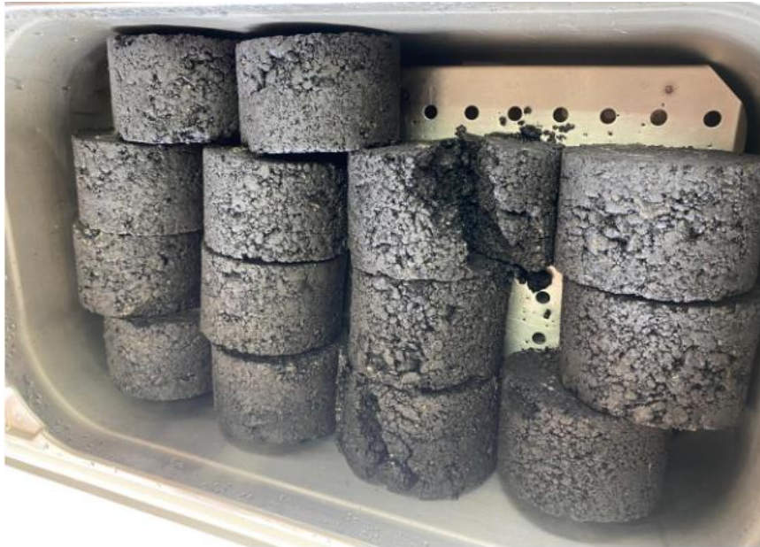
Ilustración 10 Briquetas durante las 22 horas a 60^{\circ}\text{C} \pm 1^{\circ}\text{C}
