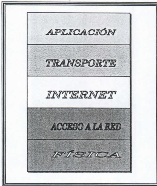
ILUSTRACIÓN 2.8.2 CAPAS DEL MODELO TCP/IP
