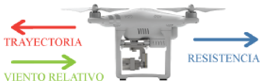
Figura 2.3: Resistencia ejercida en un drone
