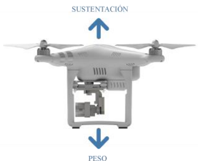
Figura 2.2: Sustentación ejercida en un drone
