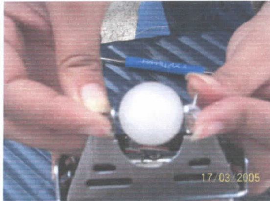
Figura 20. Montaje de la bolilla de polietileno
