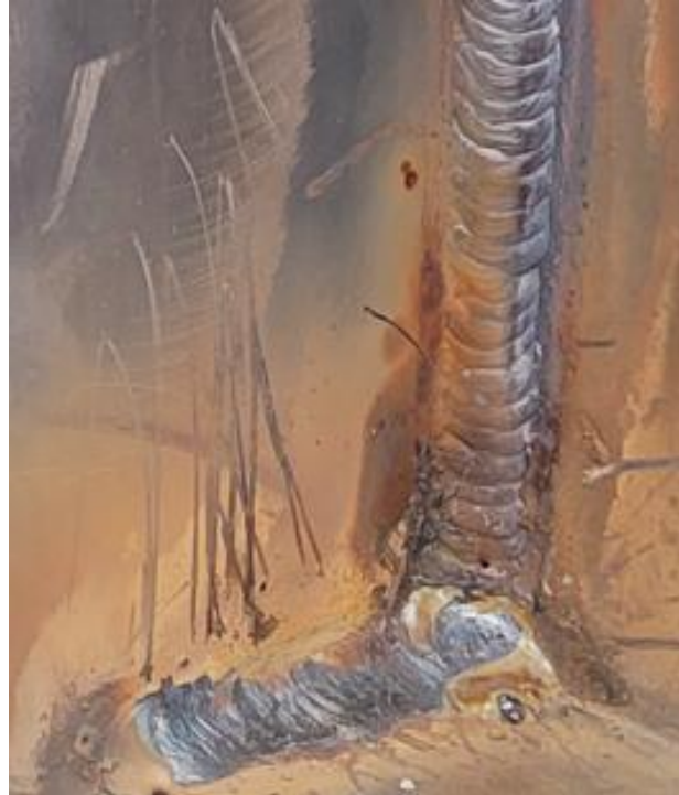
Figura 109 Defectos de soldadura – porosidades
